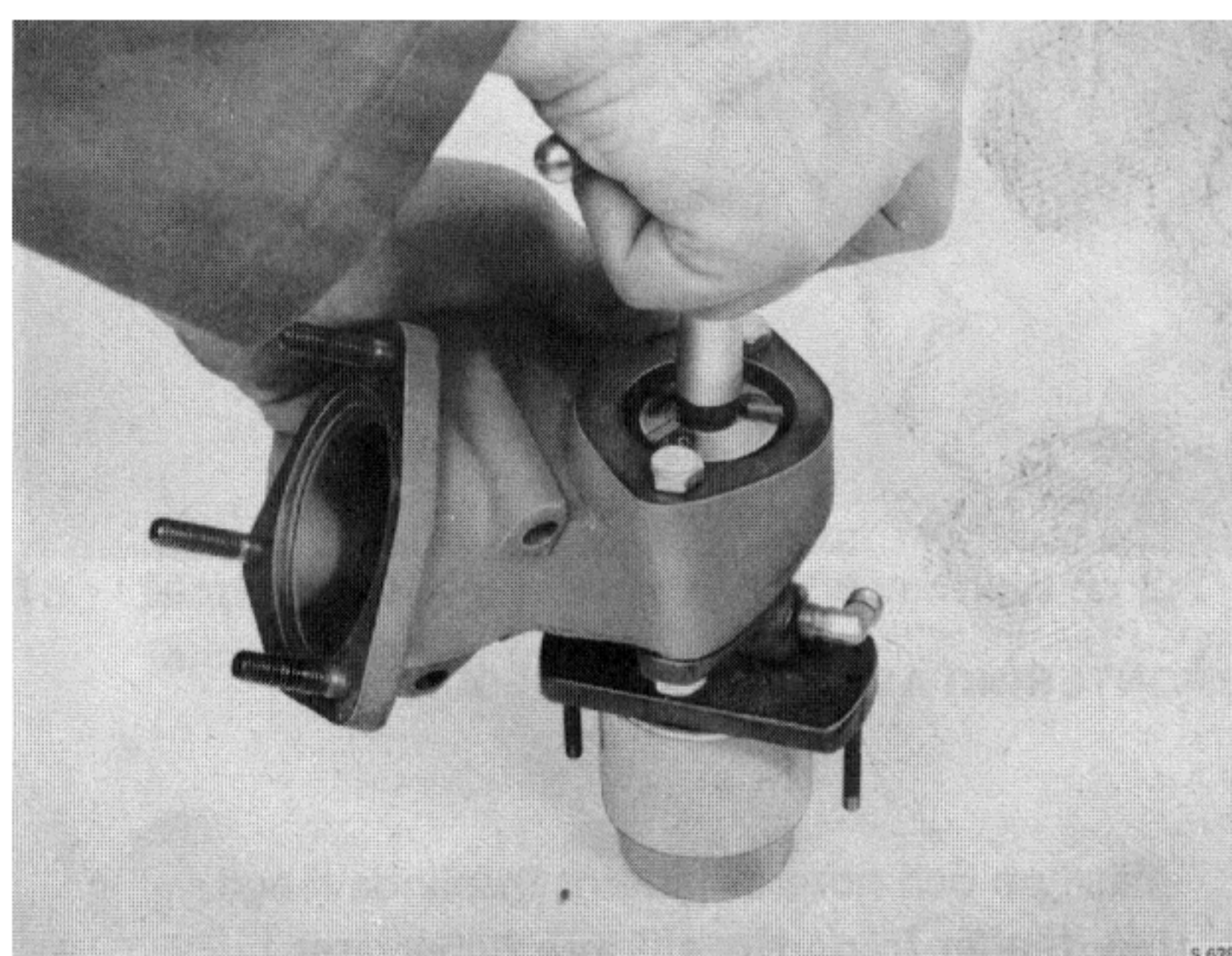
FRÄSNING AV VENTILSÄTE
