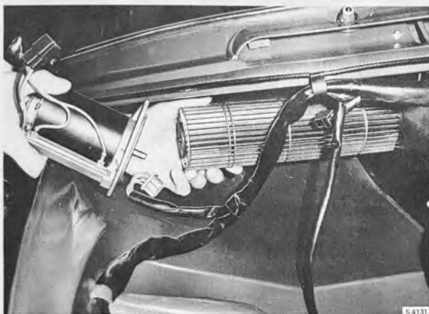
REMOVING THE FAN MOTOR
